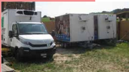
Plusieurs actions possibles ont été identifiées sur les installations de froid pour les boissons : le contrôle et l'optimisation des consignes de température, la coupure des alimentations en fin de nuit et la création d'ombrage. Ces pistes pourraient permettre de réduire la consommation d'un des postes les plus gourmands du giron (env. 30%).
