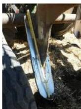
Dans certains cas particuliers, l'évaluation pédologique peut conclure à l'utilisation d'une sous-soleuse à dent droite très profonde, préalablement ou en substitution de la bêcheuse défonceuse. L'effet de fragmentation entre les dents est fortement limité; son rôle est essentiellement un rôle de drainage de l'eau en excès.
